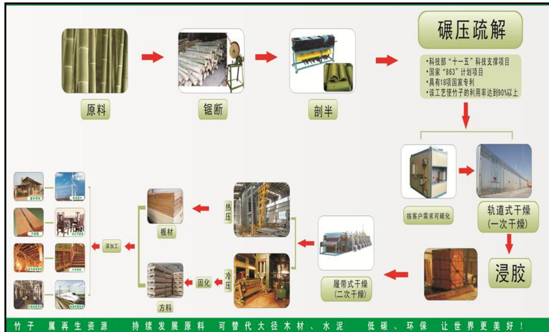
图1 竹基纤维复合材料（重组竹）制造工艺流程
