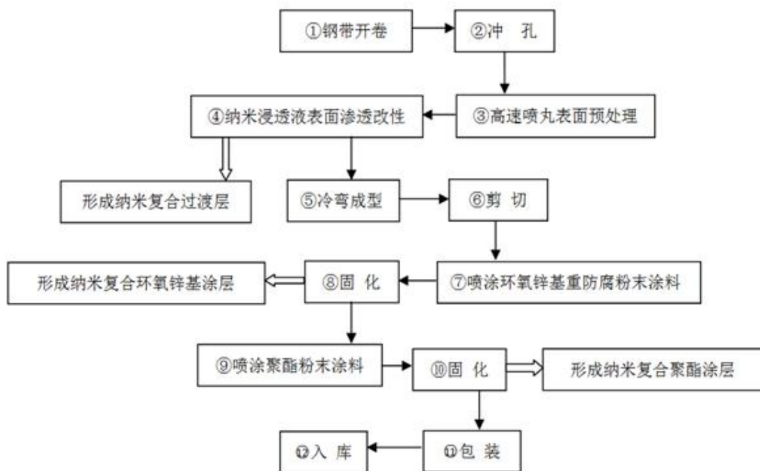
图 1 环氧锌基聚酯复合涂层钢构件生产工艺流程图
